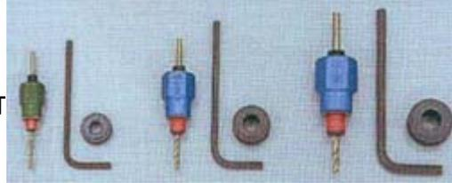
する、破損ボルト抜き取りの専用工具です。ボルトの破断面が作業面より大きく突き出している、深く埋もれていても大丈夫。硬いボルト素材に対応する最高級のコバルト製ドリル付属。
